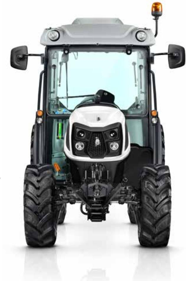
20", que lo hace aún más ágil en los espacios reducidos y en los trabajos bajo los árboles. El amplio puesto de conducción, el cuidadoso diseño del interior y el alto nivel ergonómico de los mandos garantizan una óptima comodidad, reforzada en las versiones con cabina por el eficiente sistema de climatización. Una batalla reducida de 1800 mm y el amplio ángulo de giro garantizan una excelente agilidad de maniobra incluso en las hileras más estrechas.
