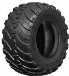
Este producto de última generación combina la tecnología VF con una banda de rodadura dotada de cinturones de acero que confiere una mayor resistencia a la carcasa y, por lo tanto, a las agresiones, como por ejemplo los agujeros y la penetración de cuerpos extraños. Actualmente está disponible en la medida VF 600/55 R 26.5.
