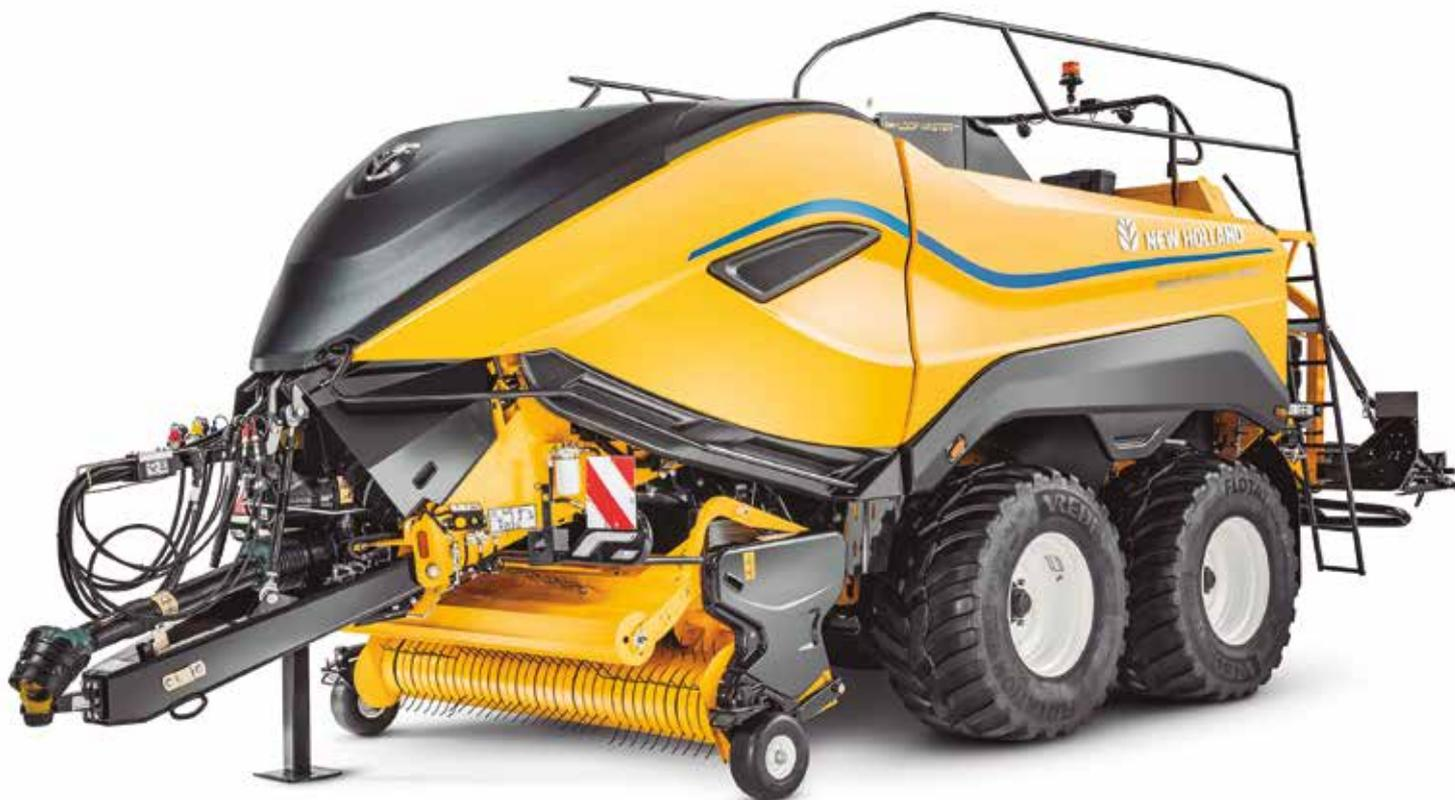
**N**ew Holland Agriculture amplía la gama BigBaler 1290 High Density, la empacadora gigante más eficiente de su segmento, con un nuevo modelo Packer. Este cuenta con tres horquillas de 3 púas fabricadas con componentes de gran resistencia para garantizar la durabilidad y la adaptabilidad a la elevada productividad de la empacadora. El nuevo modelo Packer ofrece los mismos niveles de máxima productividad y eficiencia que los modelos BigBaler 1290 High Density CropCutter™.
