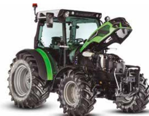
Para satisfacer la demanda de los aperos hidráulicos más complejos hay disponible una bomba de caudal a demanda (Load Sensing) que suministra hasta 100 l/min con el motor a tan solo 1.850 rev/min. Si no se requiere tanto caudal, es posible optar por el sistema de centro abierto con caudal de hasta 84 l/min. En ambos casos se pueden alimentar hasta cinco distribuidores traseros, todos ellos de control electrónico y gestión de caudal o programación del tiempo de
