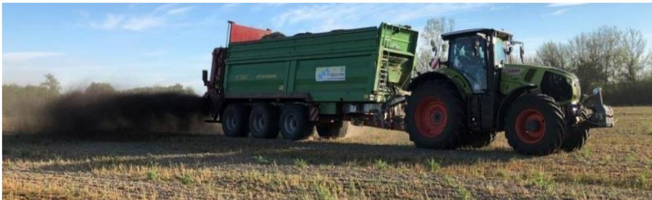
Figura 9. Esparcidor de lodo estabilizado
